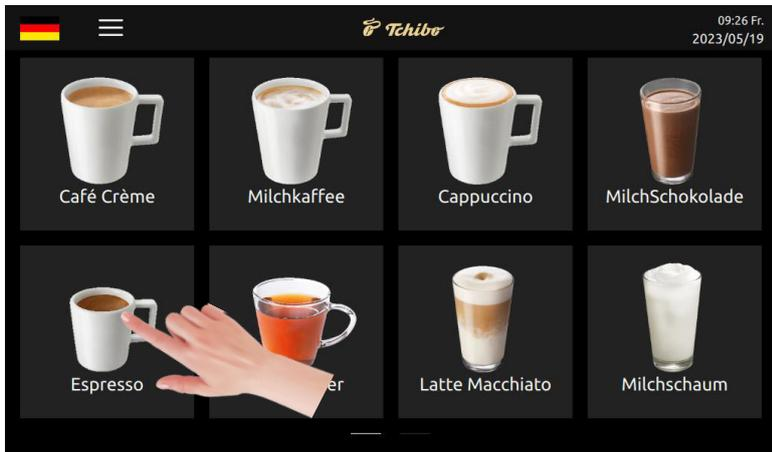
**Schritt 2:** Tippen Sie während des Getränkezubereitungsprozesses auf das „+“ auf der Seite, um das Popup-Fenster zur Parametereinstellung zu öffnen, tippen Sie auf „-“ oder „+“, um die Menge vorübergehend anzupassen (Nur im einstellbaren Modus verfügbar).
