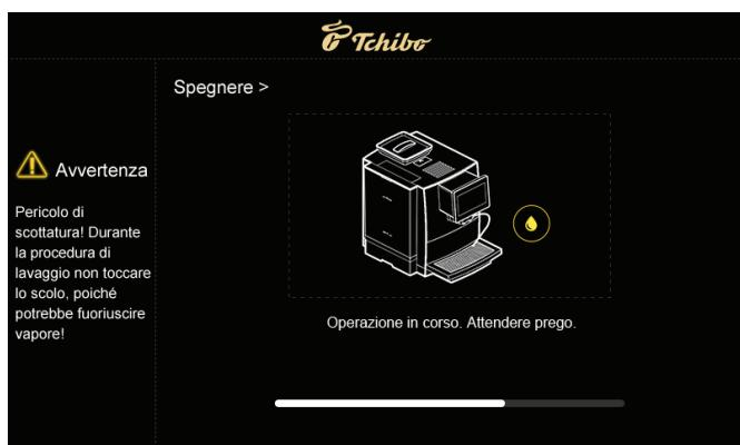
**Passaggio 5:** In modalità "Soft Shutdown", premere l'interruttore di rete sul retro della macchina per interrompere completamente l'alimentazione di corrente della macchina (attenzione: non spegnere il dispositivo direttamente, senza passare per questa fase. In caso contrario, potrebbero verificarsi danni alla macchina).
