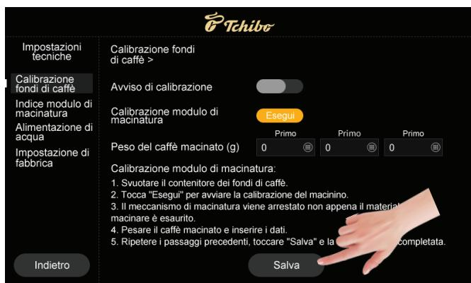
**Passaggio 1:** Svuotare il contenitore del materiale macinato, posizionarlo sulla bilancia, pesarlo e reinserirlo nella macchina.
