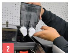
**Schritt 2:** Den Behälter entleeren und reinigen. Achten Sie vor dem Wiedereinbau darauf, dass er vollständig getrocknet ist.
