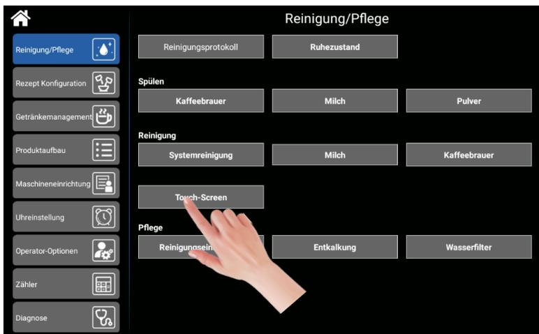
**Schritt 2:** Reinigen Sie den Bildschirm während der 10 Sekunden, in denen der Timer herunterzählt. Wiederholen Sie diesen Vorgang, falls eine gründlichere Reinigung erforderlich ist.
