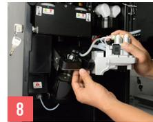
**Schritt 3:** Reinigen Sie die Brühgruppe unter fließendem Wasser oder mit einem Tuch.
