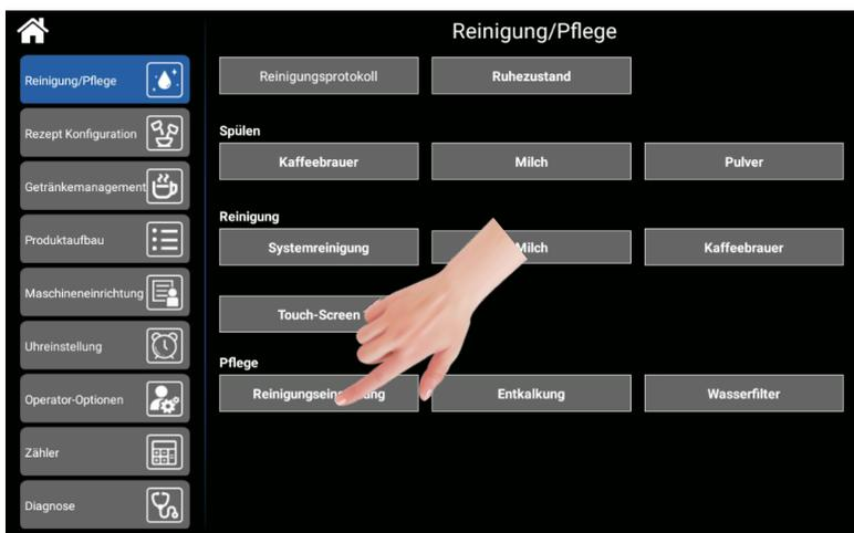
**Schritt 2:** Wählen Sie einen Tag von Montag bis Sonntag aus und stellen Sie die Reinigungszeit für die automatische Reinigung ein.
