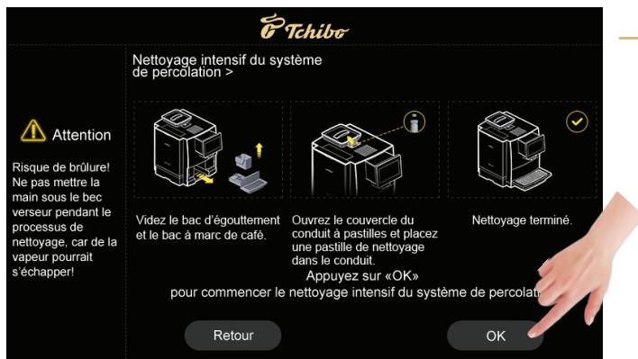
→ Pour nettoyer le système de percolation, nous recommandons d'utiliser la pastille de nettoyage pour système de percolation TCS 1.3 g
