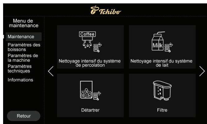
» Sous Entretien, recherchez la fonction Filtre en cliquant sur la flèche de droite. Sélectionnez la fonction Filtre.
